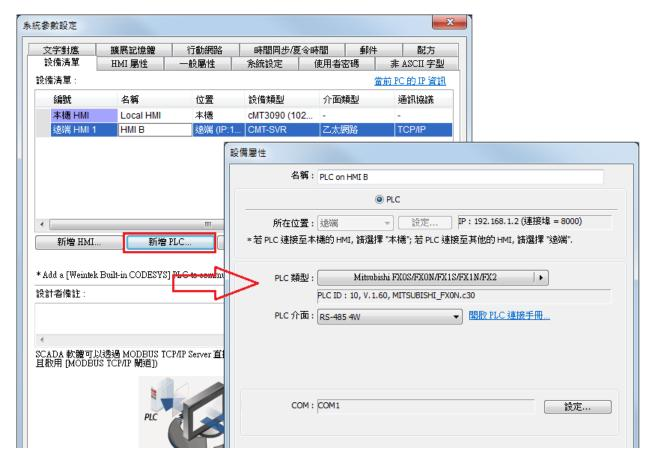
4. 建立完成後,可以看到一台遠端的 PLC 設定被建立在遠端 HMI 下面,本機 HMI 代表的是 HMI A,遠端 HMI 1 是 HMI B,遠端 PLC 1 則是 HMI B 所連接的 PLC。
