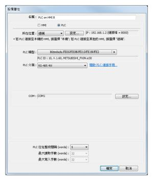
3. 設定一個位元狀態設定物件,在 [PLC 名稱] 中選擇 "PLC on HMI B",即可控制遠端 HMI B 上的 PLC。
