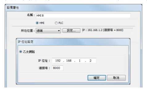
3. 設定一個位元狀態設定物件,在 [PLC 名稱] 中選擇 "HMI B",即可控制遠端 HMI 的位址。
