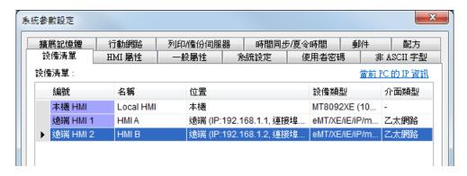
3. 設定一個位元狀態設定物件,在 [PLC 名稱] 中選擇 "HMI A",即可控制遠端 HMI A 的位址。 同樣的方式也可用於 HMI B。
