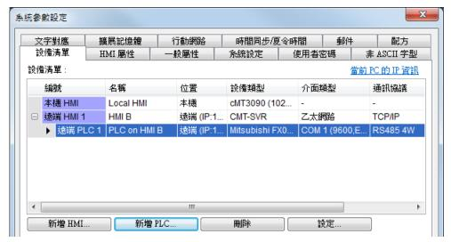
5. 設定一個位元狀態設定物件,在 [PLC 名稱] 中選擇 "PLC on HMI B",即可控制遠端 HMI B 上 的 PLC。
